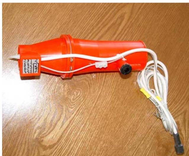
شکل ۲ سمپاش الکترواستاتیک نمونه ای از کاربرد صنعتی الکتروهیدرودینامیک
